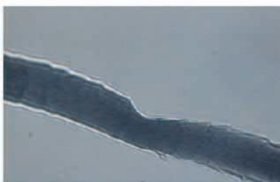
Aspetto fibra mangiata da tarme Fibre eaten by moths
