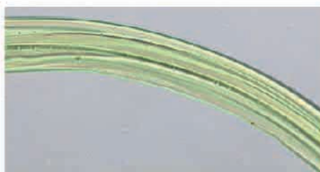
Vista longitudinale fibra di viscosa trilobata
